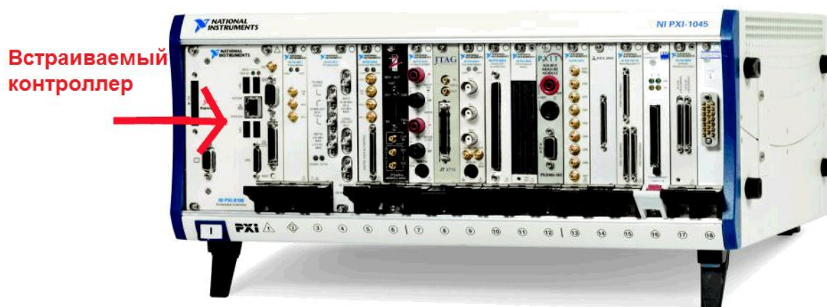
Рисунок 1: 18-слотовое шасси PXI со встроенным PXI контроллером в крайнем левом слоте (слот 1)
